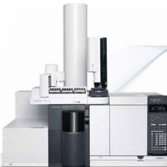
Квадрупольно-времяпролетный ГХ-МС 7200B превосходит ГХ Agilent 7890B и демонстрирует еще большую разделяющую способность благодаря включенной в него системе быстрой обратной продувки. Такие усовершенствованные характеристики 7200B, как расширенный диапазон масс, особенно полезны для анализа соединений большой массы с помощью устройства ввода твердых образцов.
