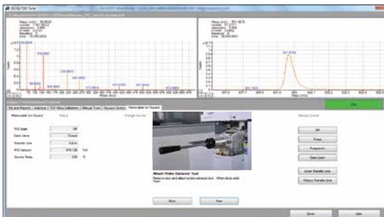
**Съемный источник ионизации** позволяет проводить его замену целиком, включая отражающую линзу, ионную камеру, экстракционную линзу и двойной катод, в течение приблизительно 30 минут без сброса вакуума.
