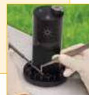
Устройство ввода твердых образцов
