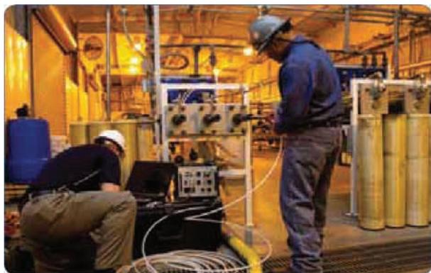
Apollo — многоканальный/многочастотный цифровой вихретоковый дефектоскоп, используемый для обычного вихретокового метода контроля, удаленного, а также широкоформатного.
