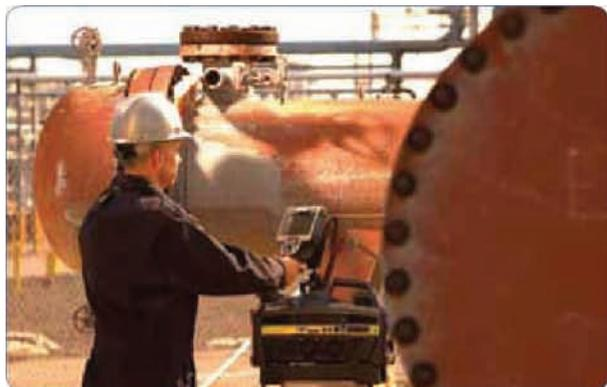
Наш видеоэндоскоп XLG3 используется, как правило, для диагностики проблем эксплуатации теплообменников и прочего стационарного и вращающегося оборудования НПЗ.
