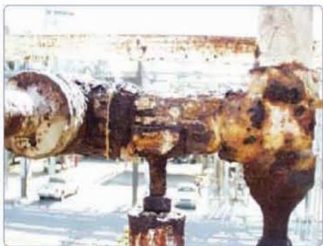
В промышленных условиях коррозия частей трубопроводов из углеродистой стали может происходить особенно интенсивно.
