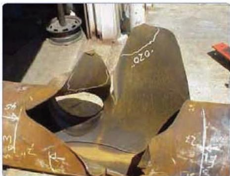
Разрыв трубы из углеродистой стали из-за коррозии под действием давления пара.
