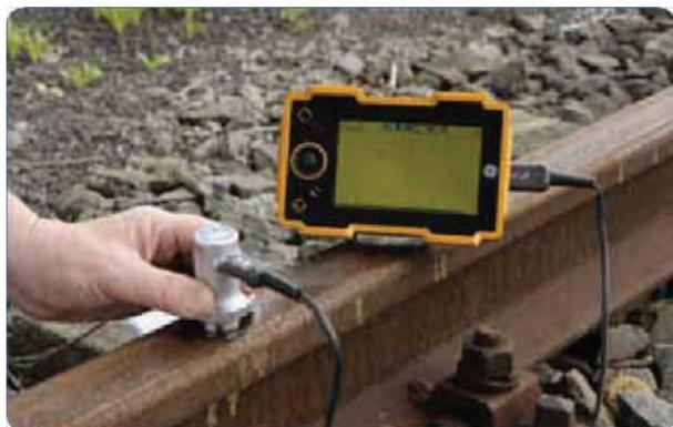
USM Go — сверхкомпактный ультразвуковой дефектоскоп массой всего 850 г. (1,87 фунта). Это изделие широко используется в труднодоступных местах.
