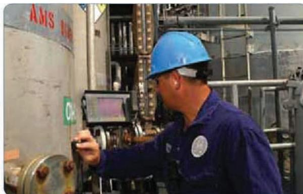
В ультразвуковом дефектоскопе Phasor CV/DM используется усовершенствованное ПО и специальные двухэлементные преобразователи с фазированной решеткой для увеличения покрытия и вероятности обнаружения дефектов в стенках резервуаров, трубах, болтах и фланцах.
