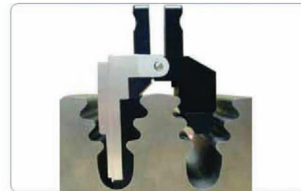
Уникальные вихретоковые зонды GE увеличивают покрытие, а также вероятность обнаружения дефектов на сложных поверхностях (например, на «ласточкинном хвосте» у ротора турбины).
