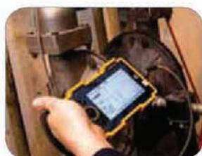
USM Go — компактный, легкий ультразвуковой дефектоскоп общего применения.
