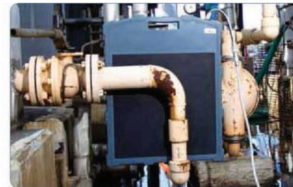
DXR250V — портативный цифровой визуально-детекторный блок с активной площадью 16 x 16 дюймов с отсоединяемым кабелем. Этот прибор обеспечивает передачу данных рентгенографии прямо на компьютер для дальнейшего их анализа.
