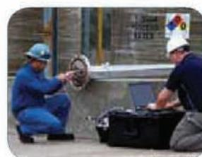
Apollo™ — инструмент вихретокового контроля, обеспечивающий получение наглядных данных трубного пучка теплообменника по эрозии и коррозии.
