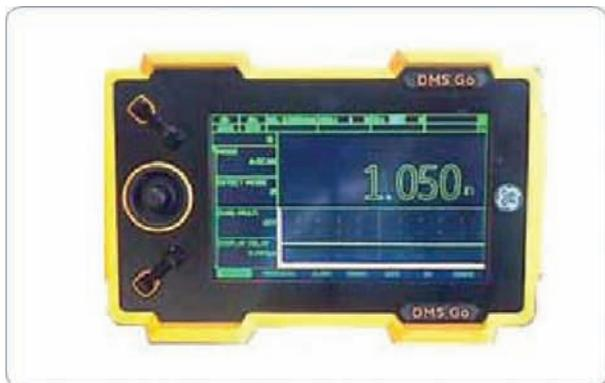
Коррозионный толщиномер DMS Go — это простой, удобный в обращении инструмент для измерения оставшейся толщины стенок корродированных труб, резервуаров и аппаратов.
