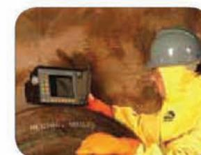
Ультразвуковой контроль с фазированной решеткой реакторов и систем трубопроводов.
