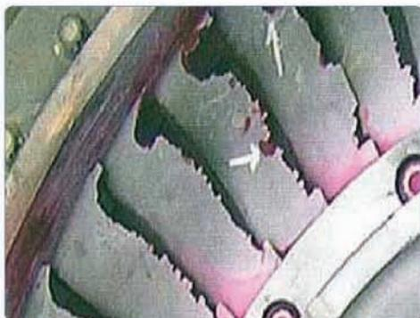
Катализатор и твердые частицы могут вызывать значительные повреждения на лопатках стационарного и вращающегося оборудования.
