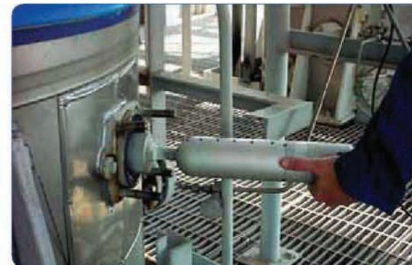
Использование камер PTZ для контроля целостности стекол и огнеупорной оболочки аппаратов.
