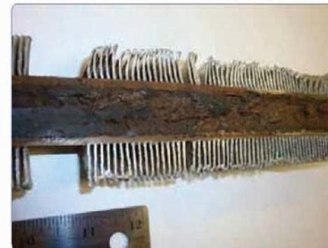
Повреждение трубок воздушного теплообменника может привести к значительным проблемам в работе.
