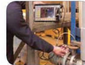
Phasor XS — хорошо зарекомендовавший себя инструмент для диагностики коррозии и трещин на контактных поверхностях фланцев на НПЗ.
