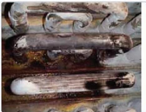
Переходные конвекционные трубы в атмосферной колонне подвергаются значительному риску коррозии из-за изменений в составе сырой нефти и повышения ее общего кислотного числа.
