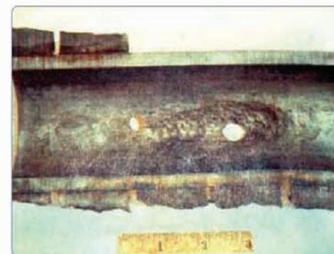
Наличие локализованной коррозии на объектах из углеродистой стали можно подтвердить с помощью визуального контроля.
