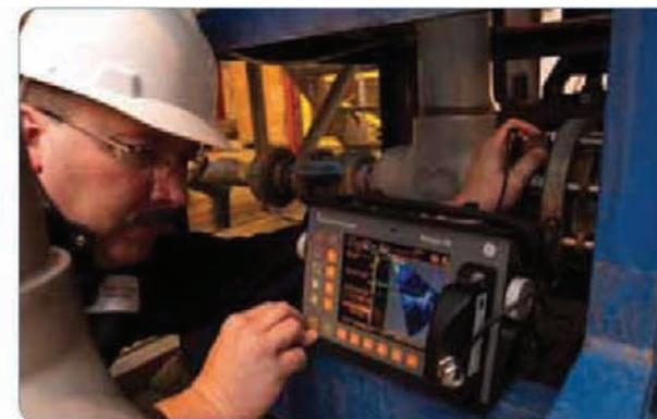
Phasor XS может применяться для таких ответственных задач, как обнаружение и оценка коррозии на внутренних поверхностях фланцев установки фтористоводородного алкилирования на НПЗ.
