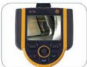
Удаленная визуальная инспекция лопаток турбины с помощью Menu Directed Inspection™.
