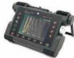
Ультразвуковой дефектоскоп DL2 с регистратором данных
