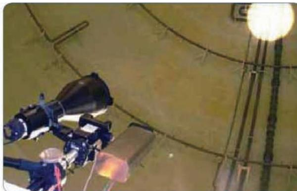
Визуальная инспекция стальной защитной оболочки реактора на предмет соответствия нормам ASME IWE с помощью 5-мегапиксельной системы получения изображений.
