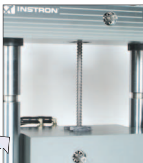
▲ Имеются встроенные захваты, находящиеся в V-образном пазу, или плоские пластины для испытания таких образцов, как прутки, плита, труба, лист и провод.
