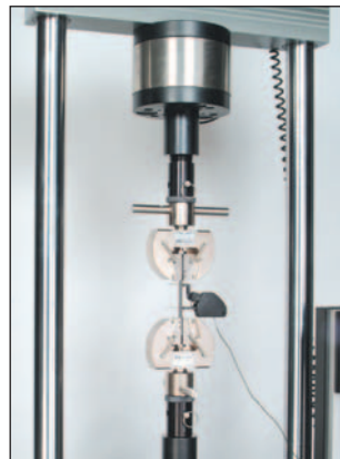
▲ Возможна также установка внешних фиксаторов, адаптеров и переходных адаптеров для установки самых разных образцов при испытаниях на растяжение, включая крепежные детали (слева), композитные материалы (в центре) и проволоку (справа).
