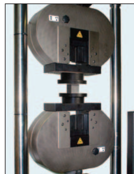
▲ Дополнительный набор адаптеров с уже установленными компрессионными пластинами позволяет проводить испытание на сжатие без снятия захватов.
