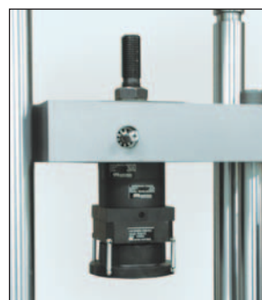
▲ Мост с тягой для испытаний на сжатие позволяет устанавливать фиксаторы для испытаний на сжатие и изгиб в нижнем рабочем пространстве машины без снятия сферических тяг.
