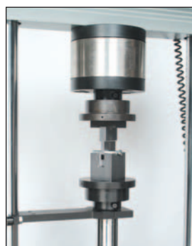
▲ Фиксатор для испытаний на сдвиг может быть адаптирован для испытания крепежных деталей, арматуры и компонентов.
