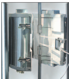
▲ Печи и крепежные приспособления можно устанавливать на испытываемые материалы и при повышенных температурах.
