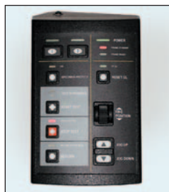
▲ Панель контроля эффективности обеспечивает удобный доступ к наиболее часто используемым функциям, таким как: Пуск/Стоп, Обнулить канал, Загрузка/Разгрузка и Установка базовой длины.
