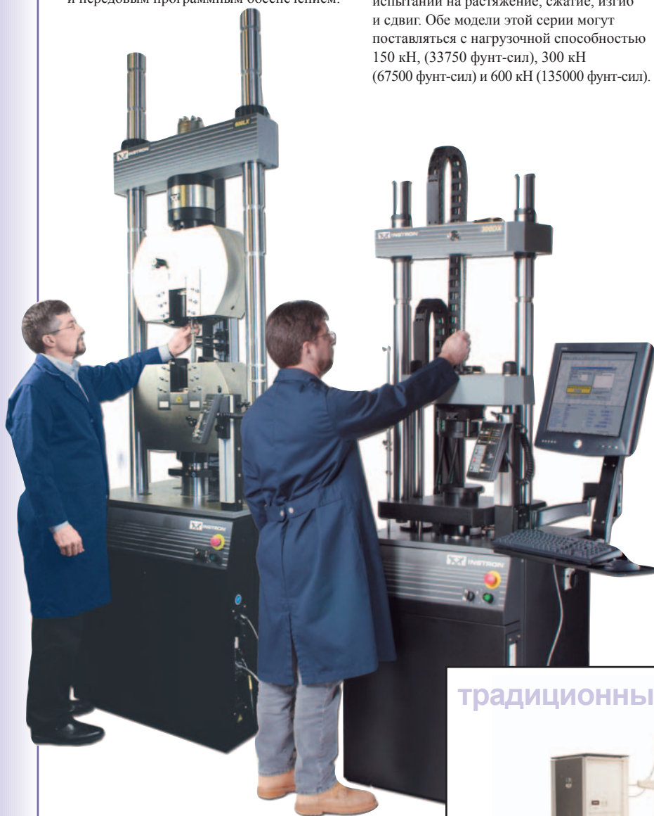
▲ Рама 600LX, приспособленная для испытаний металлов (слева). Рама 300DX, приспособленная для испытаний арматуры (справа).
