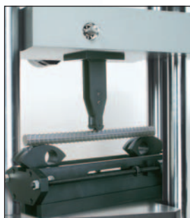
▲ Возможна также установка внешних фиксаторов и адаптеров для выполнения испытаний на изгиб, сдвиг и сжатие на самых разных образцах, включая арматуру (слева), бетон (в центре) и образцы грунта (справа).
