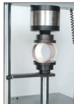
▲ Для расширения сортамента испытываемых материалов и компонентов к этому набору могут быть добавлены компрессионные пластины.
