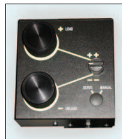
▲ Дополнительная панель ручного управления обеспечивает ручное управление без обратной связи силовым приводом машины, прецизионными средствами управления поворотными клапанами для загрузки/разгрузки и быстро перемещающимся клапаном для настройки положения привода перед испытанием и после него.
