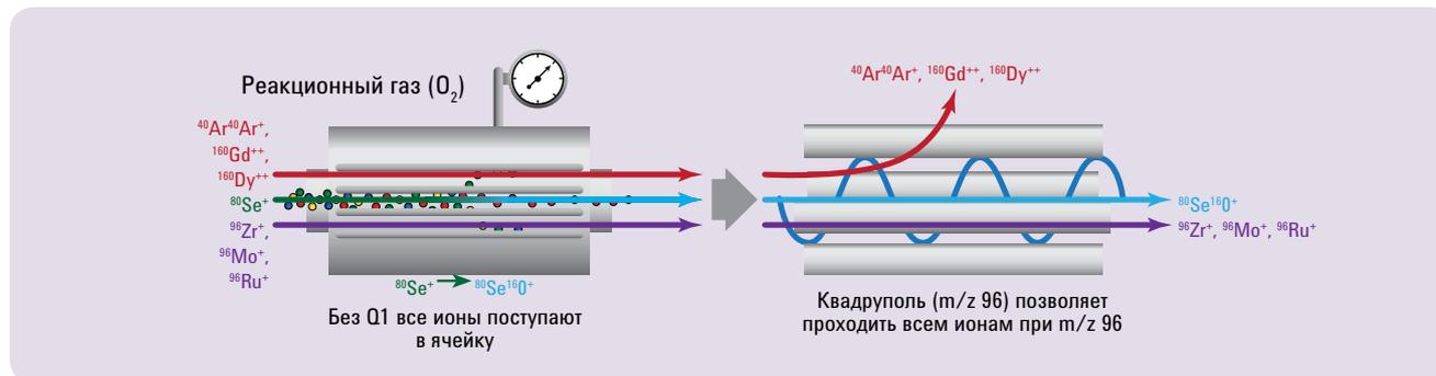
**Б. ИСП-МС с тройным квадруполем.** Q1 позволяет проходить в ячейку только ионам при m/z 80, а все остальные ионы будут устранены. <sup>80</sup>Se<sup>+</sup> преобразуется в <sup>80</sup>Se<sup>16</sup>O<sup>+</sup> в ячейке с реакционным газом O<sub>2</sub>. Q2 измеряет SeO<sup>+</sup> при m/z 96. Zr, Mo и Ru не могут вызвать помехи, так как они отсеяны с помощью Q1.
