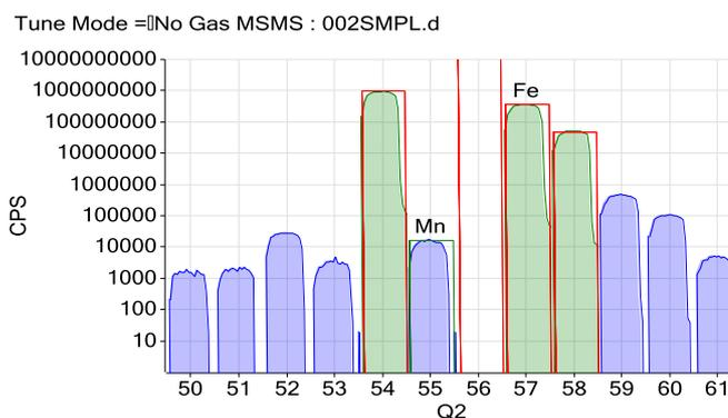
Непревзойденная чувствительность МС/МС к относительному содержанию позволяет определять следовые количества (1 ppb) Mn на фоне 1 000 ppm Fe. Спектр показывает, что пик следового Mn при  $m/z$  55 полностью отделен от пиков Fe при  $m/z$  54 и 56 (выходящий за пределы рабочего диапазона пик  $^{56}\text{Fe}$  проигнорирован автоматически).
