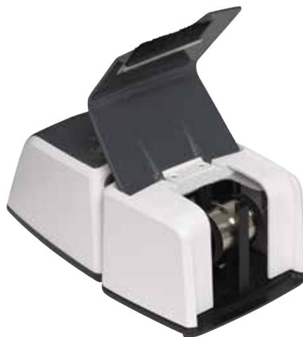
Рис. 3. Газовая кювета в модуле пропускания
